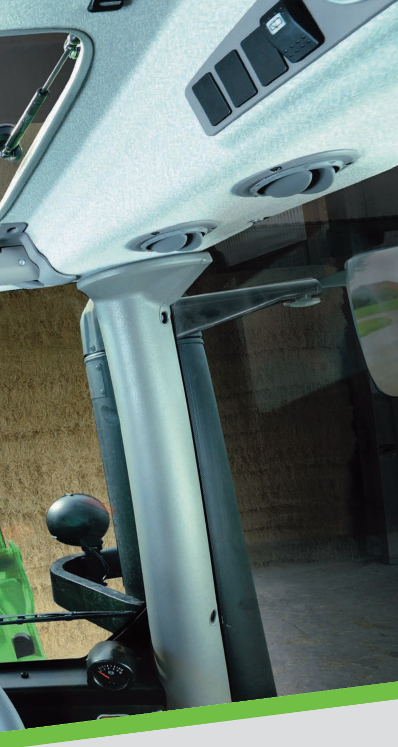
Poignée de chargeur frontal avec boutons Powershift. Stop&Go, système de direction rapide SDD...
