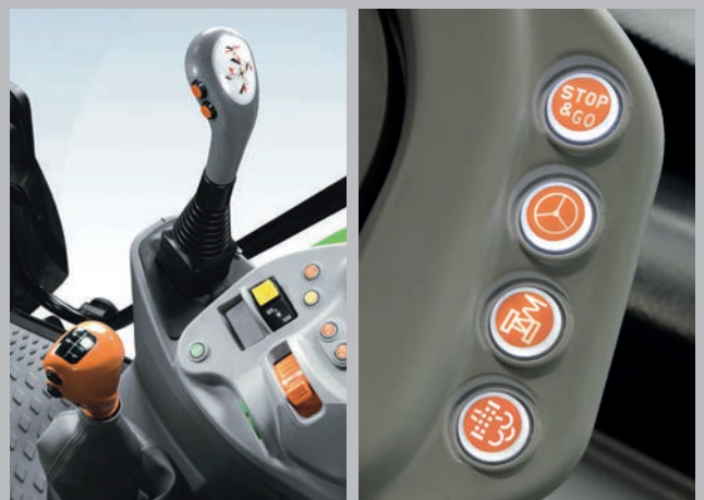
Poignée de chargeur frontal avec boutons Powershift. Stop&Go, système de direction rapide SDD...
