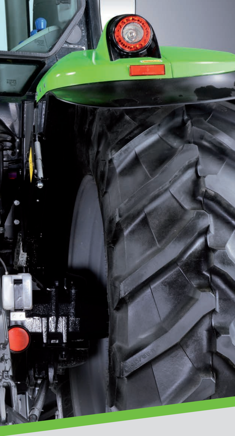
Points d'attelage avant. Capacité de levage de 2 100 kg et PDF 1 000.
