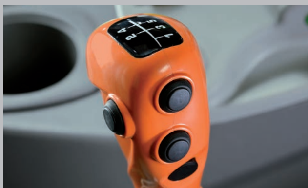
Comfortclutch et Powershift. Changez simplement de rapport par pression sur un bouton sans enfoncer la pédale d'embrayage.
