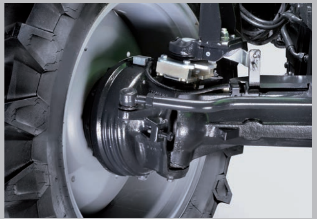
Un concept de sécurité unique DEUTZ-FAHR. Freins à disque séparés refroidis à l'huile sur les roues avant même en 2 roues motrices.
