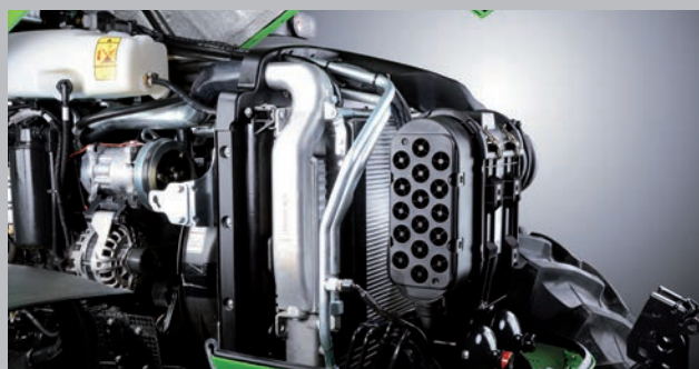
Système de refroidissement facile à nettoyer avec son ventilateur à viscoupleur (en option).
