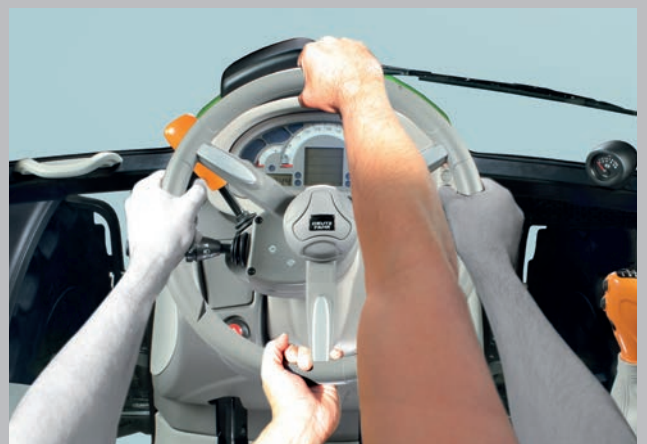
Système de direction rapide SDD. Rotations du volant divisées par deux.
